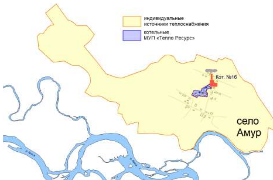
Рисунок 3.1 – Зона действия источников тепловой энергии с. Амур
