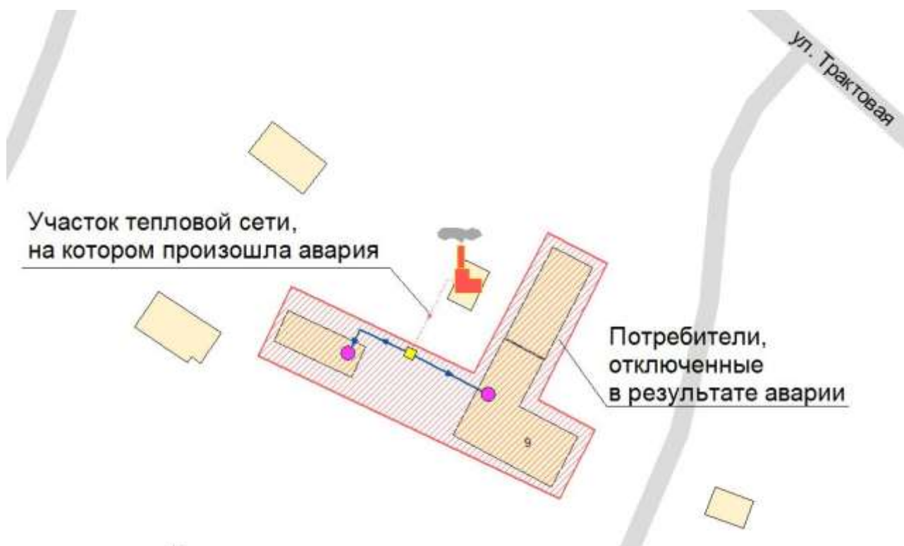
Рисунок 2.11 – Моделирование аварийной ситуации на котельной №17, с. Абай
