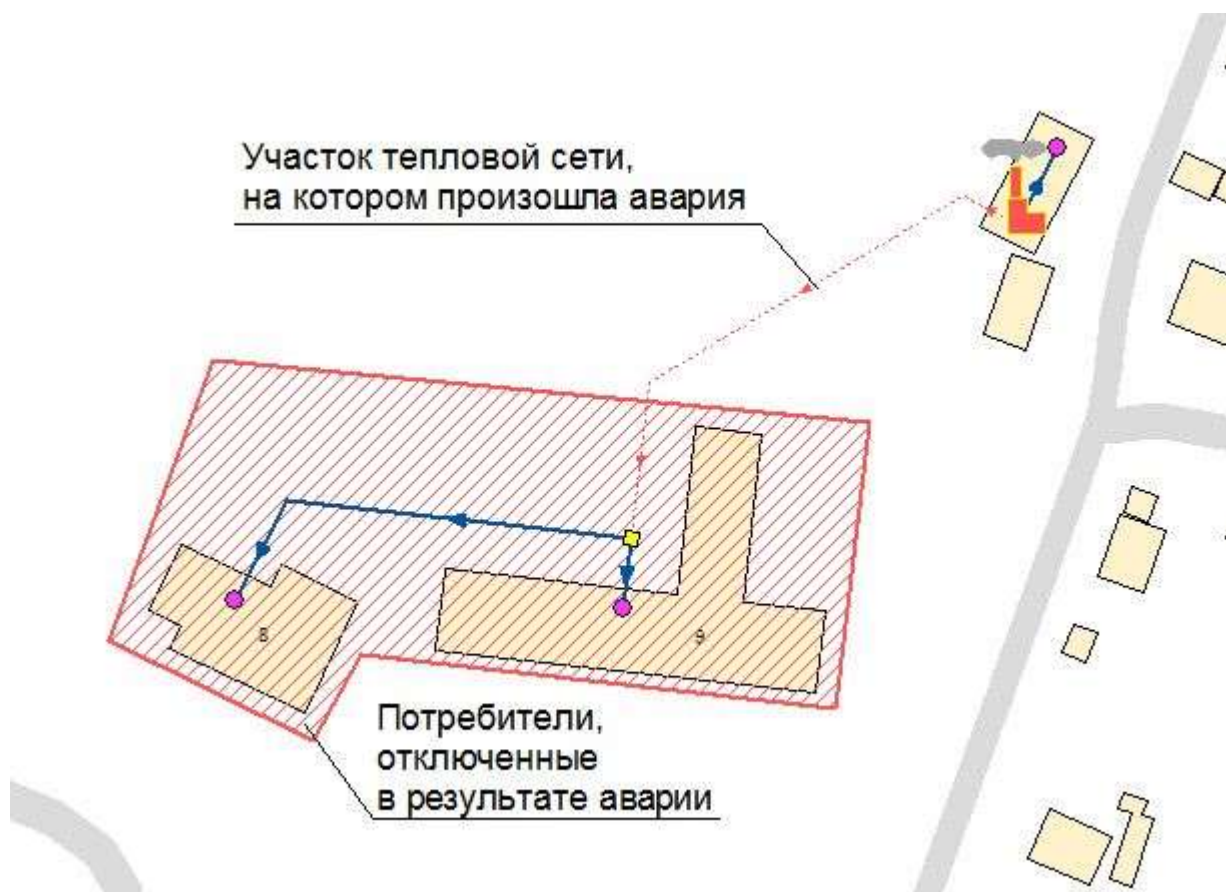
Рисунок 2.10 – Моделирование аварийной ситуации на котельной №16, с. Амур
